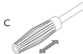
Zur Erreichung des Niederdrucks Varioregeldüse verschieben !
