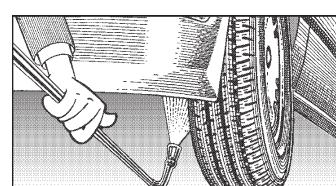
Nettoyage de bas de caisses pour voitures, camions et appareils. Lance de 90 cm, racourcée, avec buse HP et raccord ST30. Lors de la projection, la lance doit être en contact avec le sol.
