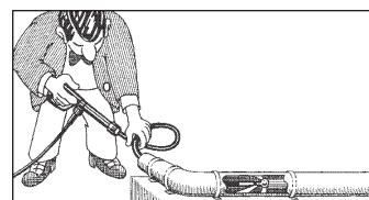
Nettoyage de tubes ou de canalisations. Tuyau de nettoyage de canalisation avec buse KN et raccord ST 30, M 22 x 1,5
