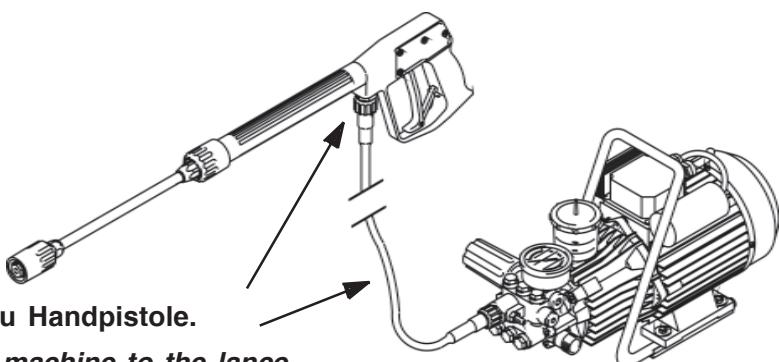
D Verbindung Hochdruckschlauch von Gerät zu Handpistole.
